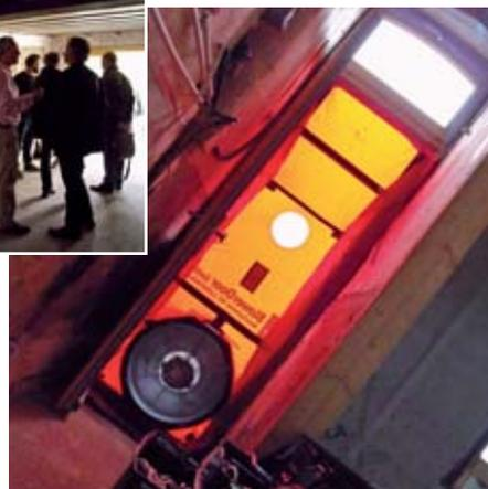
Appareil de mesure de l'étanchéité de l'air
